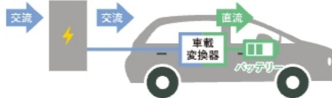
普通充電器は、交流をそのまま充電するため安価で機器もコンパクト。車載変換器が交流から直流に変換しバッテリーへ充電を行う。
