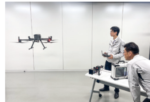
レーザーによるドローン追尾制御の実験
