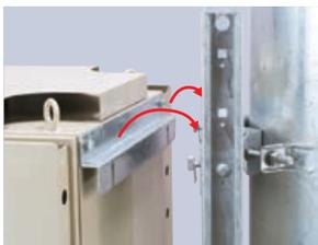
取付金具(上)の四角ボルトに振止金具を引っ掛けて仮固定します。その際、キャビネットを支持金具(左/右)に載せてください。
