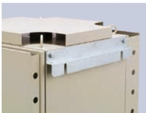
キャビネット側面の上部に振止金具を取付けた後、アイボルトを使って取付金具の高さまで吊り上げます。
