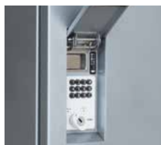
暗号プッシュキー ワンタイム式の暗証番号キーを採用して いるため、複数の世帯で共用できます。
