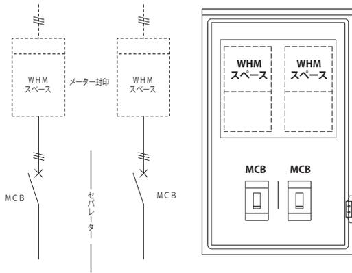
回路図/内部配置図
