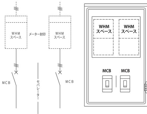
回路図/内部配置図
