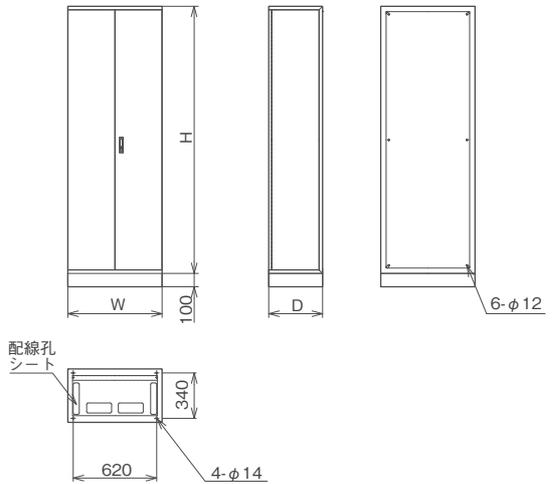
注)チャンネルベースを外してアンカー固定を行う構造です。
