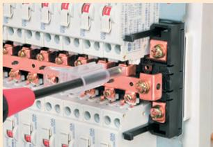
電圧切替補助部材のガイド穴を変更する部位の隣の穴に差込み切替部材を固定し、ネジを緩めます。
