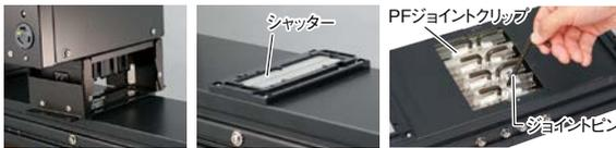
サーバーラックごとのプラグインホールに分岐ボックスを接続します。プラグインホールは接続時にだけシャッターが開くので安全です。連結するバスダクトユニット導体接続部にはPFジョイントクリップを採用。ジョイントピンを1/4回転させて引き抜くだけで導体の接続が完了します。
