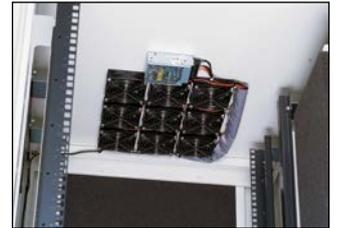
天井面に設置したDC9連ファンからの排熱量は2300W! 外気を下部の吸気口から吸い込み、暖気を天井から排出する効率の良い熱循環を可能としています。
