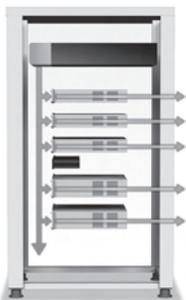
ダウンフローによりサーバ前面へ冷気を供給します。
