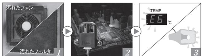
フィルタが著しく目詰りしたり、ファンの風量が急激に低下した場合にセンサが感知。
