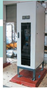
神戸地震波800galの耐震試験クリア
