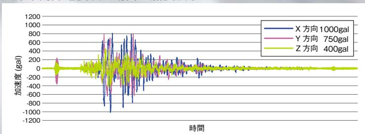
兵庫県南部地震波(増幅)1000galの耐震試験をクリアしています。ラックに850kgの荷重を搭載し兵庫県南部地震波の加震試験を実施。阪神・淡路大震災時の地震波(震度7)は800gal、1000galはその1.25倍に相当します。
