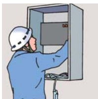
木板基板をねじ止め
