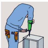
取付け穴、配線口を 穴あけ加工
