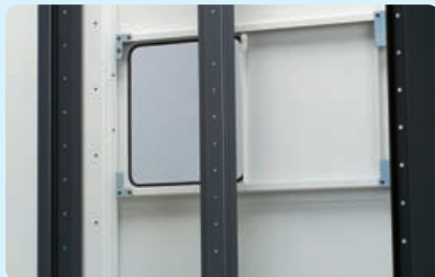
配線小窓 ラック間の通線口としてサイドパネルにスライド式の小窓が奥行き800mm以上に設置できます。ラック高さ2000mm以上の場合・2箇所までラック高さ1750mm以下の場合・1箇所まで
