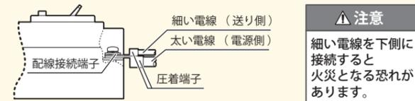
※太い電線を必ず下側にして接続してください。
