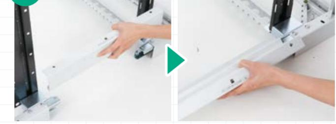
連結フレームを斜めに挿し込みセットした後、ボルトで緩く締付けます。
