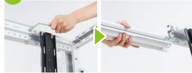
左右に組付けてある連結フレームを取外します。
